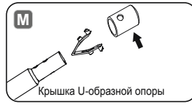
Подпружиненный штырь вертикальной ножки бассейна
