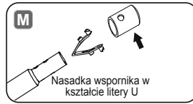
Zacisk sprężysty do pionowych nóżek basenu
