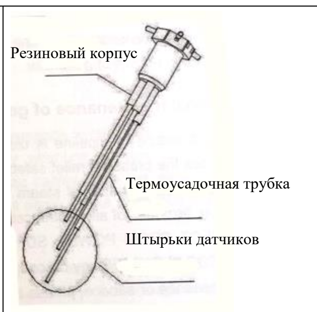
Рисунок 6 Схема датчика уровня воды
