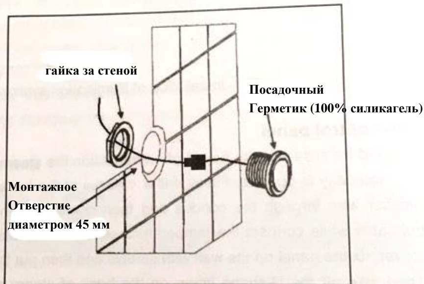
Рисунок 16 Установка контроллера
