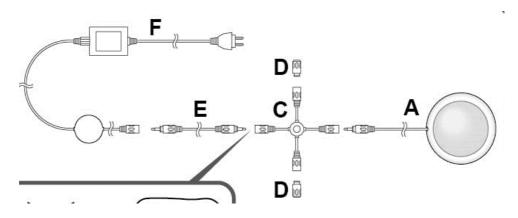
Подключение дополнительных прожекторов
