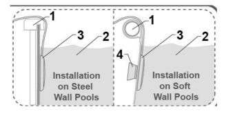
Поместите прожектор в бассейн и зафиксируйте его с помощью магнитного держателя с внешней стороны бассейна.
