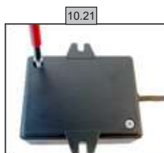
10.21 Снимите основание модуля Wi-Fi.
