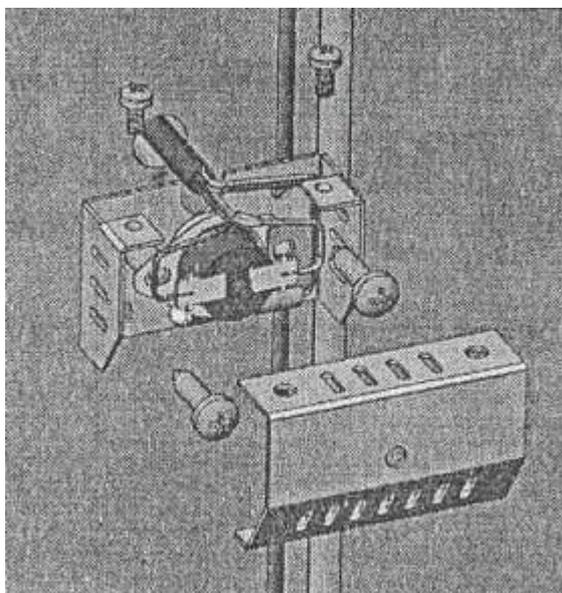
Рисунок 3. Монтаж коробки датчика температуры
